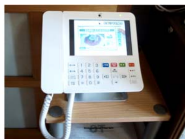
IP告知システム ビーちゃんねつと端末(出典:岩泉町ホームページ) 地域IPネットワーク網を活用して、役場と住民の双方間で、JALERT・地震・台風・豪雨・津波などの災害時緊急放送や行政放送を行うもの
