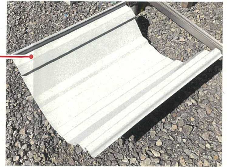
金属折版屋根： フッ素ガリバリウム鋼板 シルバーグレー
