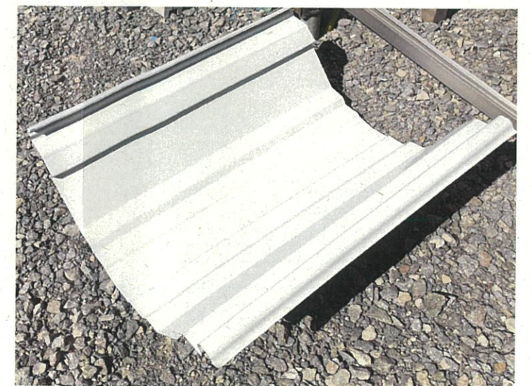
金属折版屋根： フッ素ガリバリウム鋼板三重葺き シルバーグレー
