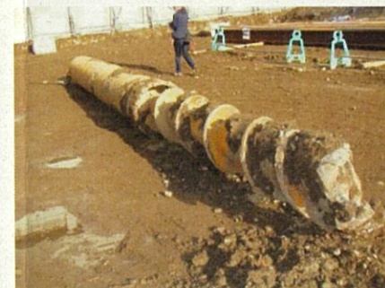
オーガー軸 破断
