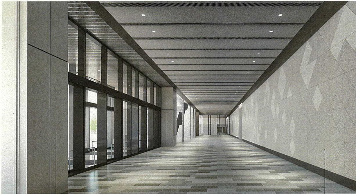
柱型：押出成形セメント板 カラークリア塗装 サッシ・自動扉：ブラック
