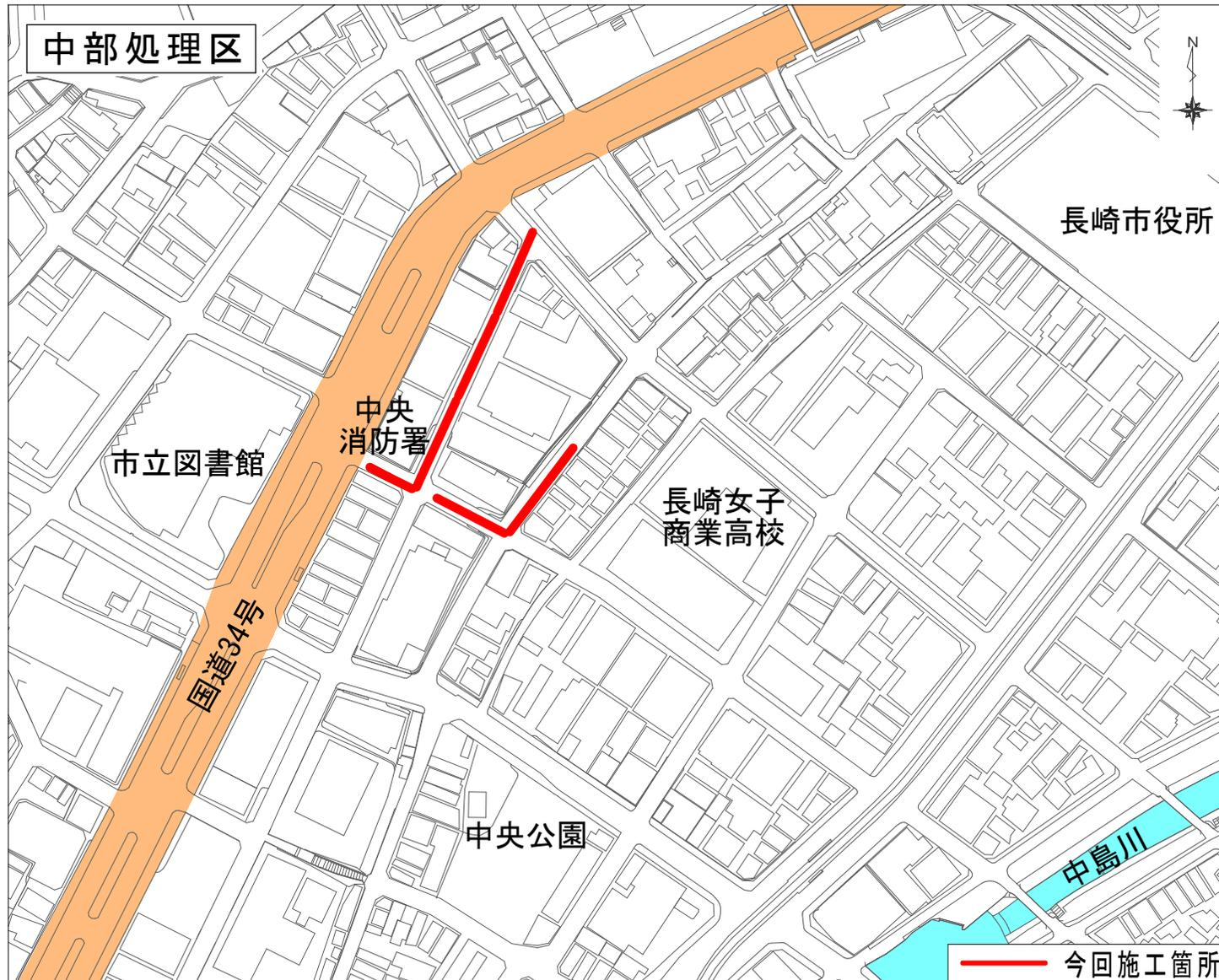
管路の維持管理において、老朽化等による事故発生等を未然に防止するため、下水道ストックマネジメント計画に基づき、老朽化した既設管内面に新たな管を設ける管更生工事を行っている。
