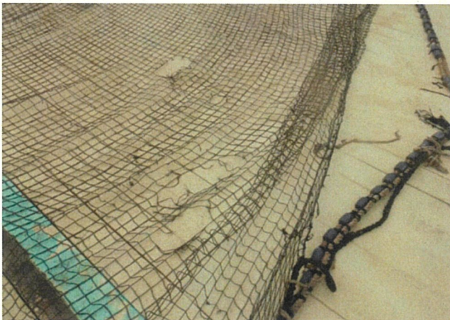
網底部分のロープ部分（鉛を配置）と上部網部分が大きく裂けている
