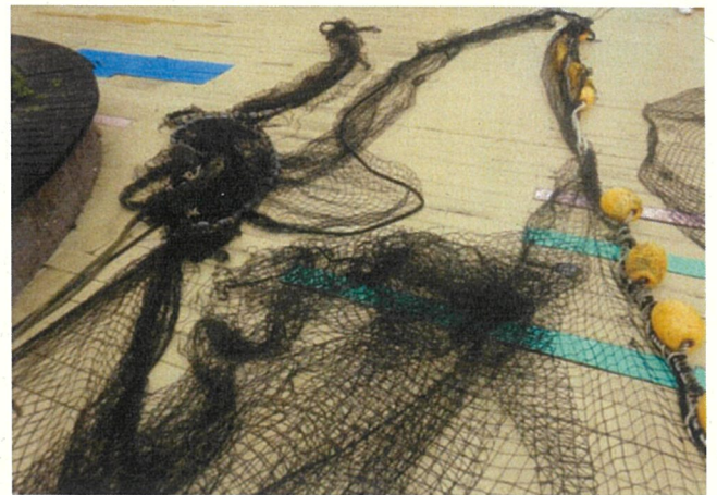
網上部分（浮きを配置）から網中部、下部にかけて大きく裂けている
