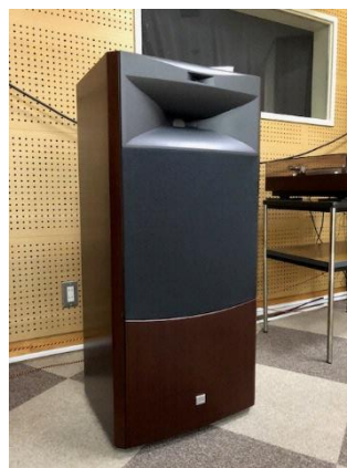
視聴覚室のスピーカー ◎JBL S4700 380mm径3ウェイ・フロアスタンディング・スピーカー
