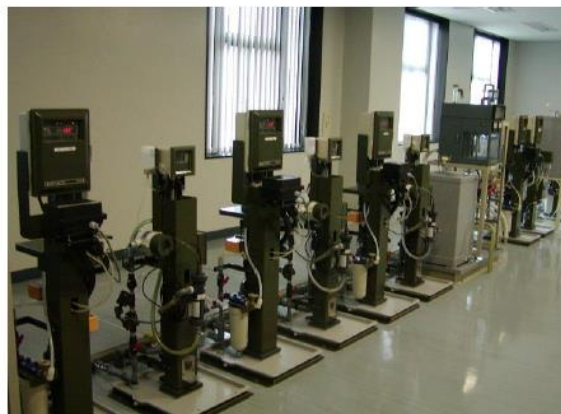
各種水質監視計器 （濁度、pH値、アルカリ度、色度 残留塩素）
