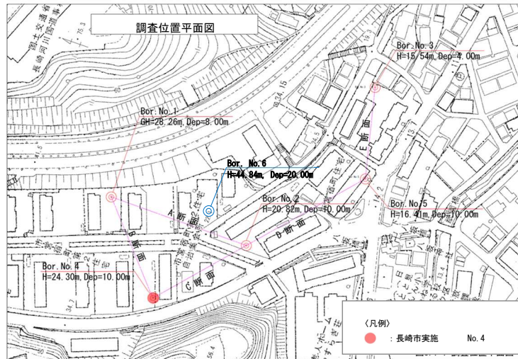
No. 4 孔 (掘進長：10.00m, 孔口標高：GH=24.30m)
