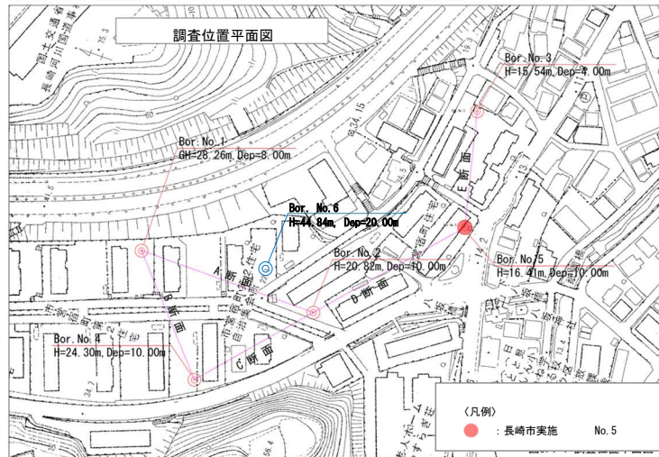
No. 5 孔 (掘進長: 10.00m, 孔口標高: GH=16.41m)
