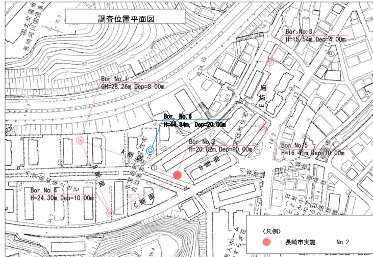
No. 2 孔 (掘進長: 10.00m, 孔口標高: GH=20.82m)
