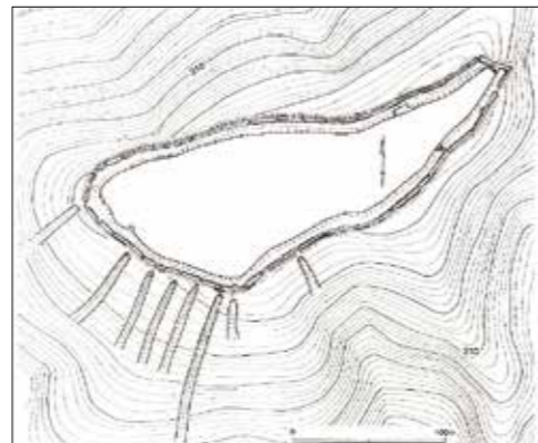
石城の縄張構造 城山に築かれた石城は、本丸や二の丸、三の丸のない一重（単郭）構造で、この形態は西海地方多い。そのなかでも圧倒的に巨大な規模を誇り、当時の勢力の大きさが伺い知れる。斜面には畝状堅堀群が残る。 (長崎県教育委員会：長崎県中近世城館跡分布調査報告書、長崎県文化財調査報告書第206-207集)
