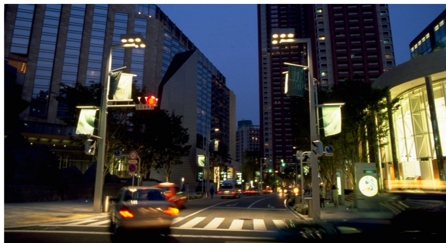
交差点と横断歩道が合理的にハイライトされている車道の事例（東京）
