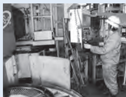
大型の縦型旋盤を使って、機械加工を行っています
