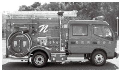
900L水槽付き消防ポンプ自動車
