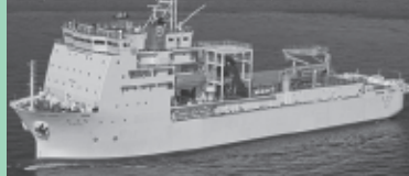
海底ケーブル敷設船「さずな」
