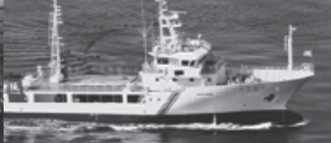
海底ケーブル敷設船「おりおん」
