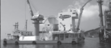
コンクリートミキサー船「グラバー」
