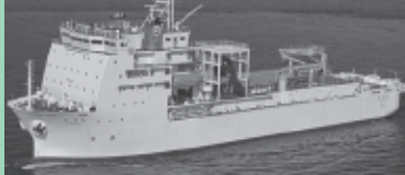
海底ケーブル敷設船「さずな」
