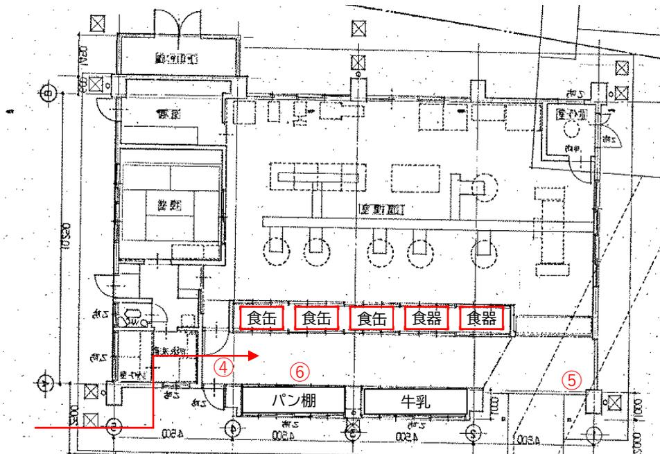
資料11 配送校の搬入経路図及びコンテナ配置図
