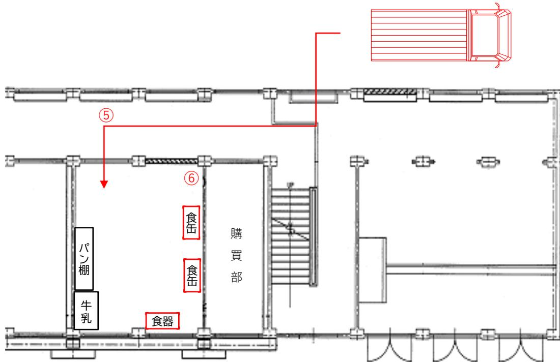
資料11 配送校の搬入経路図及びコンテナ配置図
