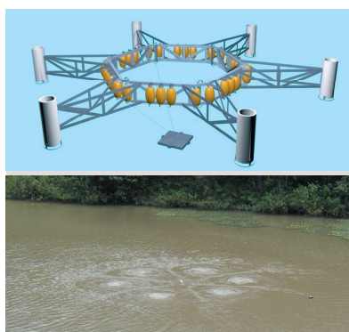
閉鎖性水域水質改善装置 子水神（ネレード）
