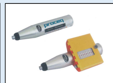
シュミットハンマー(FTS株式会社) コンクリートに打撃を与え、返ってきた 衝撃により強度を推定するもの。
