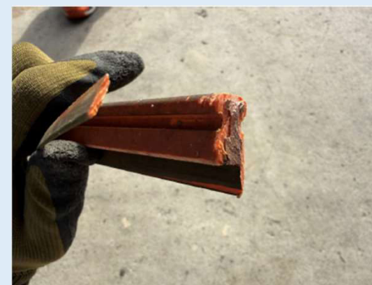
写真6. 割れた絶縁部(稲佐山)
