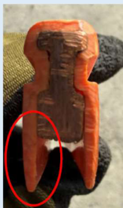
写真4. トロリー断面(新品)
