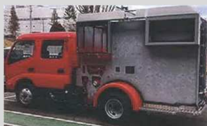
②骨格組立 (消防ポンプ取付)
